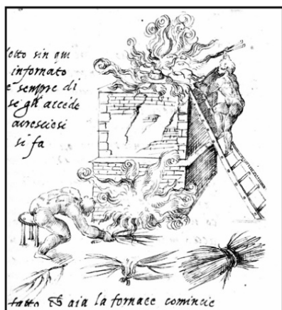
تصویر ۱۱. طراحی پیکولپاسو، کوره چوب‌سوز در حال احیاء و دوددهی (رادز، ۱۳۸۲: ۶۰).
