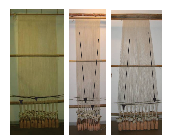
تصویر ۷. تأثیر استفاده از وزنه های نامناسب با عرض چله در دستگاه پارچه بافی وزنه ای عمودی (Hann, 2005, 26).
